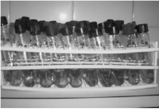
Figura 4 – Os 50 tubos de ensaio contendo 1 cone cada, imersos em caldo de BHI.
