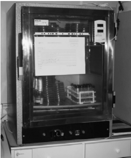
Figura 5 – Estufa bacteriológica com os tubos de ensaio, onde foram incubados a uma temperatura de 37°C por 72 horas.
