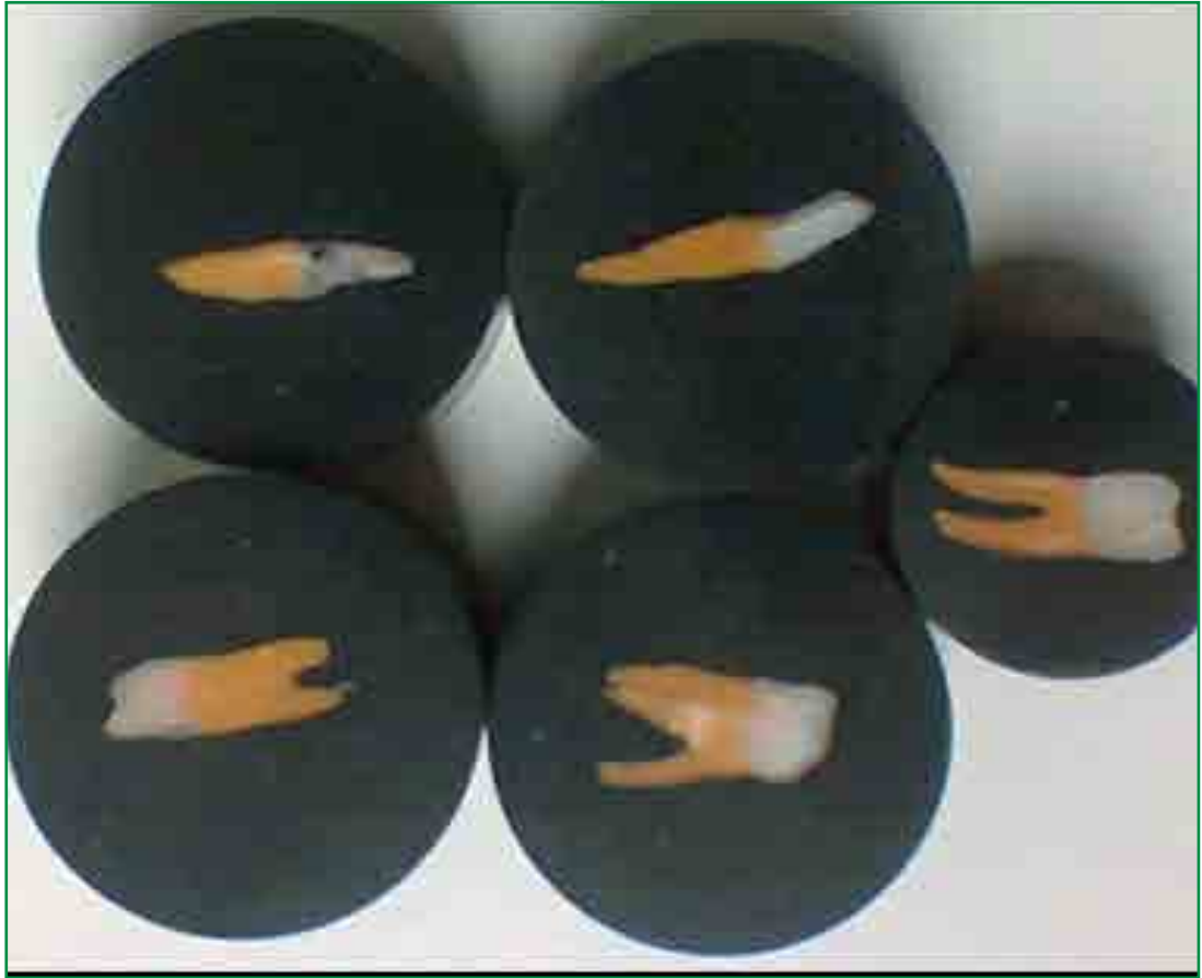
Figura 5 – Corpos de prova com os dentes artificiais embutidos após lixamento e polimento.
