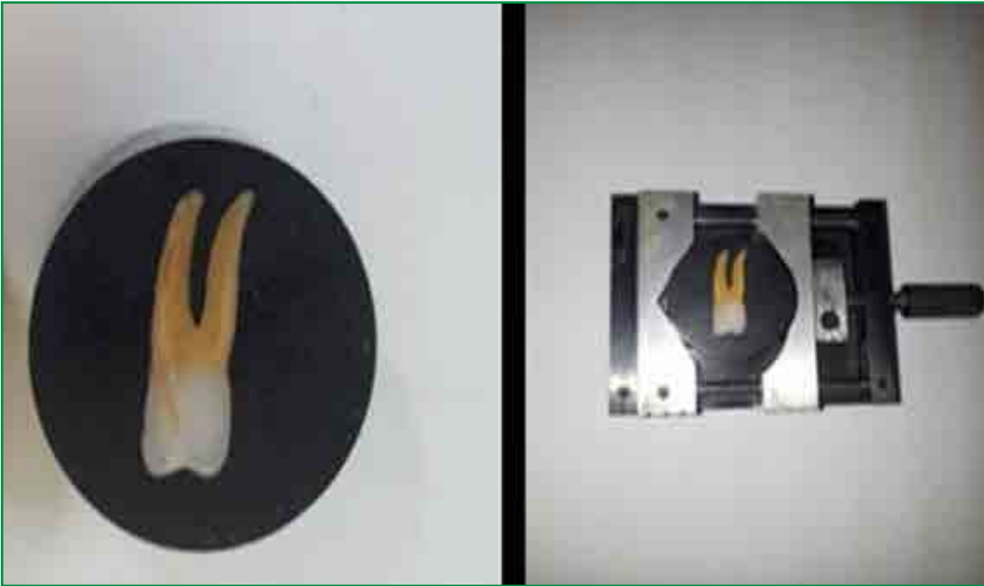
Figura 7 – Dente artificial montado no suporte e levado ao microscópio para leitura
