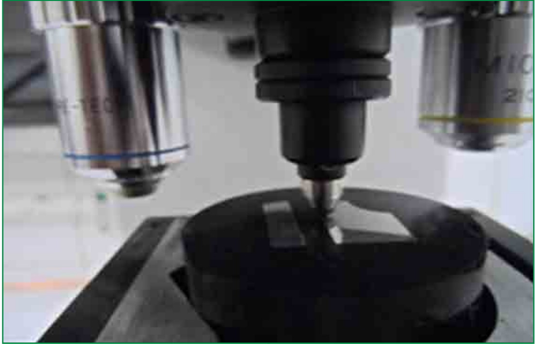
Figura 9. Exemplo da aplicação de carga pelo penetrador no ensaio de microdureza Vickers
